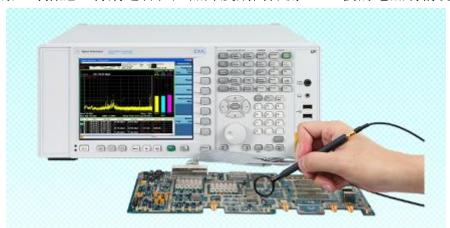
EMC标准认证测试,是远场测试。远场测试能给出频率信息,即哪些频点超标了,但是没有位置信息。为了通过测试,需要从源头上来采取措施,所以需要应用近场测量来寻找干扰源。通过电子电路的开关和充电电流导致模块远场干扰超限。根据模块的特定谐振特性,通过引起的超限干扰,这些电流在远场产生特定频率的负效应,即像"天线"一样,通过电流或场束耦合机制,干扰源传送到谐振导体系统和结构组件。
