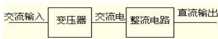
线性直流稳压电源是先将交流电经过变压器变压，再经过整流电路整流滤波得到未稳定的直流电压，要达到高精度的直流电压，必须经过电压反馈调整输出电压，可以达到很高的
