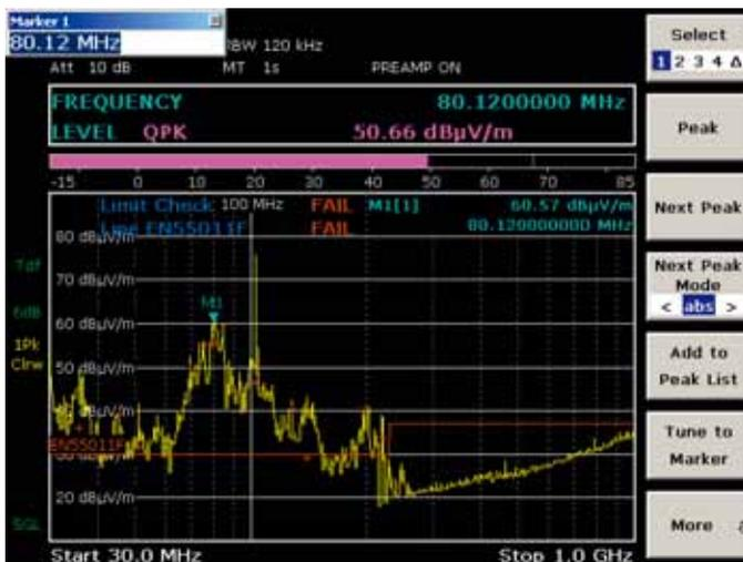
测量曲线的设置菜单。最多可以同时用6个不同的检波器进行扫描，并同时显示。ESL会自动标记出那些临界的频率点用于终测。
