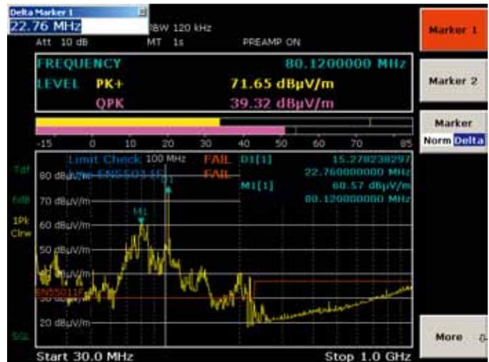
利用标记和缩放功能可以精确而方便的评估所有的测量曲线。曲线标记以及调谐到标记功能将当前标记点的频率和电平值同时测量出来。这些功能明显的简化了测试工作，大大缩短了终测的时间。
