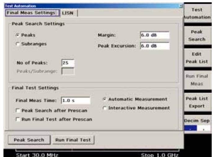
所有终测的参数设置都集在一个界面里，非常方便。可以通过绝对峰值或者子频段内最大值两种不同的方式来选取终测的频率点。也可以在该界面里设定距离限值线的距离以及最大测量点数（从1到500），终测支持手动以及全自动两种方式。
