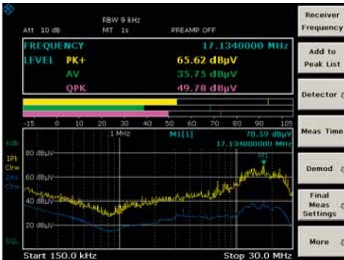
在接收机模式下接收机主要参数设定的菜单。在上半个屏幕持续更新显示所选检波器和频率的电平值（最多4个），下半个屏幕显示使用扫描模板设定参数的辐射信号的频谱，最多可以显示6条不同的曲线。
