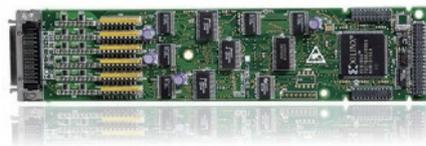
ProDAQ 3610高速DIO功能卡是一款安装在VXI总线主板或LXI主机上的高集成度功能卡。这款高速DIO功能卡有48个通道，是专用在一些要求高的场合：从一般的低速数字输入输出到高速的模式生成和模式识别。如果8块DIO功能卡安装在一块ProDAQ主板上，这功能卡就提供给用户384个输入输出通道。
