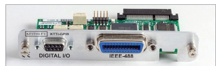
KTTI-GPIB GPIB 接口及 6 个 I/O 端口
