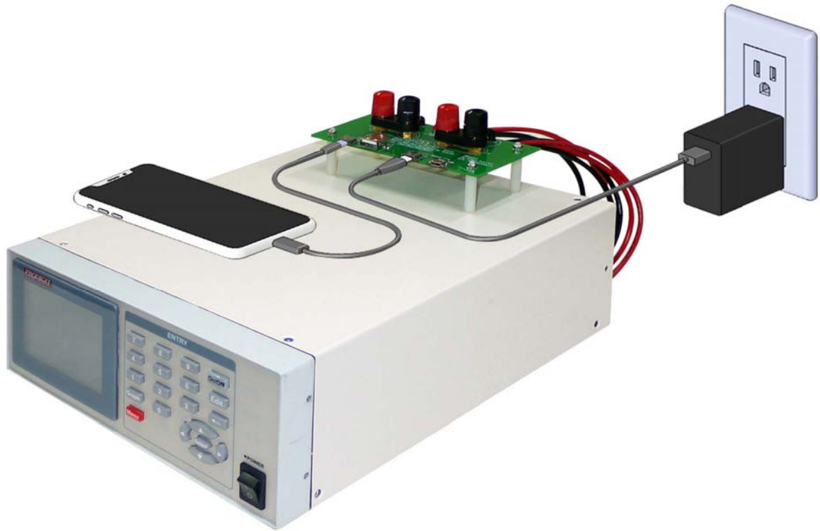
手機充電量測連接示意圖 〈充電器電源端USB Type C & 智慧手機負載端USB Type C〉
