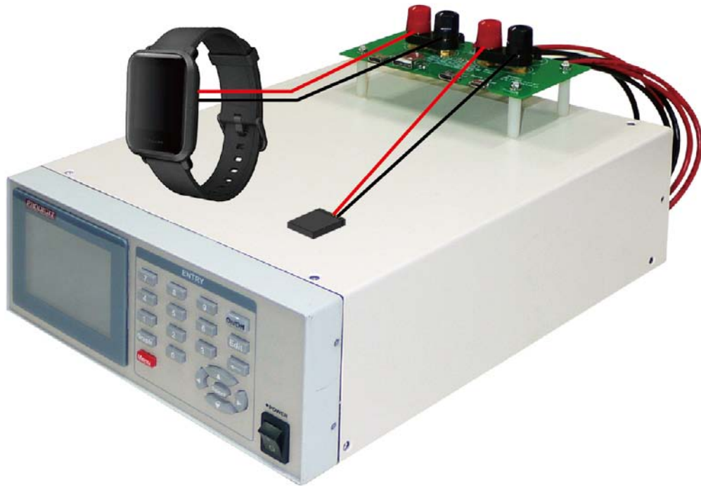
智慧型手錶充放電量測連接示意圖
