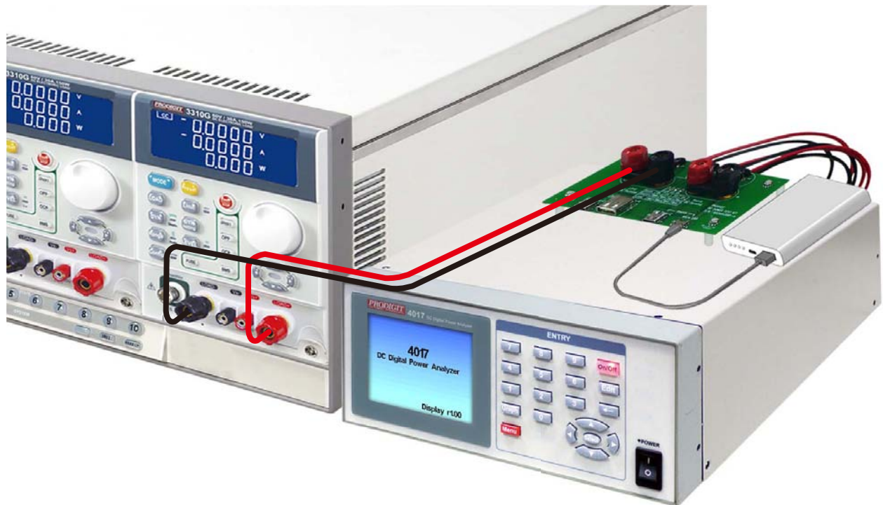
Power Bank放電量測連接示意圖 〈電源端Micro-USB & 負載端 紅黑接線柱〉
