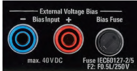
后面板上的外部偏置电压端口
