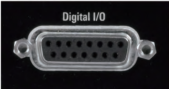
后面板上的数字 I/O 端口
