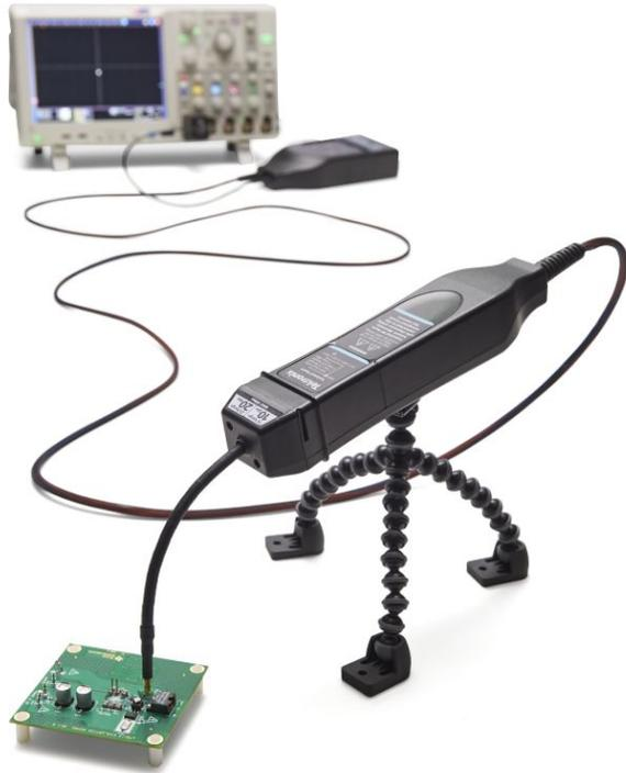
海洋仪器推出的泰克TIVM系列IsoVu™测量探头系统提供了一种电流隔离测量解决方案，在存在大的共模电压时，可以准确分辨高达±50Vpk的高带宽差分信号，在其整个带宽中提供了同类最佳的共模抑制比。
