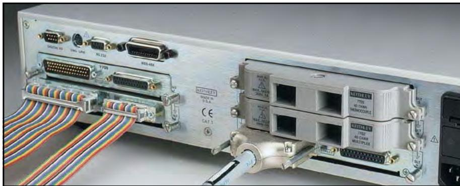
2750型主机中可以安装多达5个输入模块 (或者, 在2700和2701主机中可安装多达2个)。所有的开关/控制模块完全封闭在耐冲击塑料里, 以保证出色的坚固性。三个可替换的连接器, 简化了模块到被测设备的连接。坚固的D-sub连接器允许快速、稳固的连接, 而且在进行日常维护或当系统安装在机架上时特别方便。7701、7707和7709型模块附带IDC带状电缆适配器, 在生产测试和过程监控应用中, 可快速、简单的联网。对于需要极高的连接灵活性的应用, 特大号的螺钉固定端子连接器简化了它们的设置。其他D-sub和IDC带状电缆连接器工具包和预先连线的电缆组件则单独出售。
