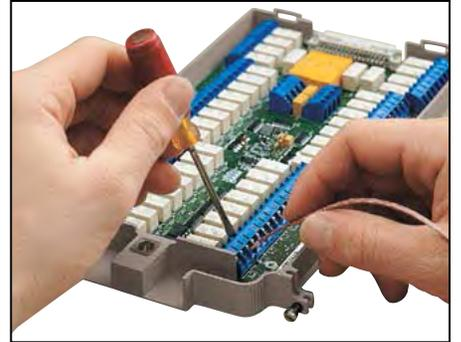
螺钉固定端口使用特大型接头，用于容易的、无差错的布线。某些机型上可选择易于使用的可拆除端子
