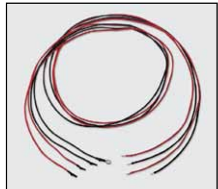
Model 2260-009: 250V 和 800V 型号测试线组, 两组红线和黑线, 20AWG, 1.22m (48 英寸), 一端是剥开的线, 另一端是盒。
