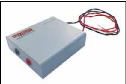
Model 2260B-EXTERM-HV: 250V 和 800V 型号扩展端子；测试线和端子盒，把输出带到仪器前面或另一个位置。磁性底座连接到仪器侧面。
