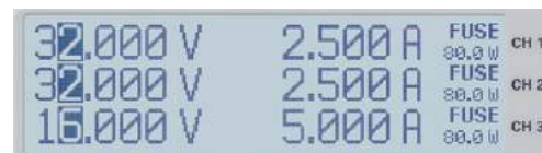
Abb. 5.1: 1-V-Position aller drei Kanäle (R&S®HMP2030)
