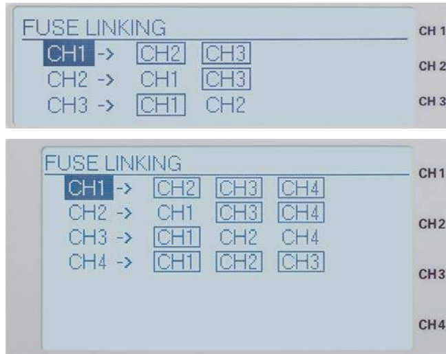
Abb. 3.3: Fuse Linking R&S®HMP2030 (oben) / R&S®HMP4040 (unten)
