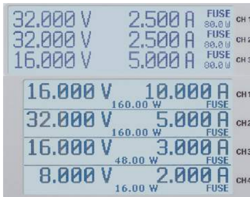
Abb. 4.7: R&S®HMP2030/ R&S®HMP4040 Fuse-Darstellung im Display
