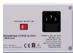
Abb. 1.1: Netzspannungswahlschalter beim HMP2030
